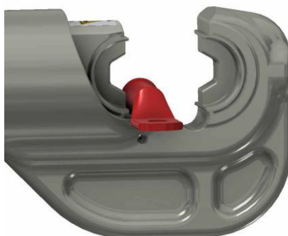
INCORRECTA POSICIÓN DEL CONECTOR
